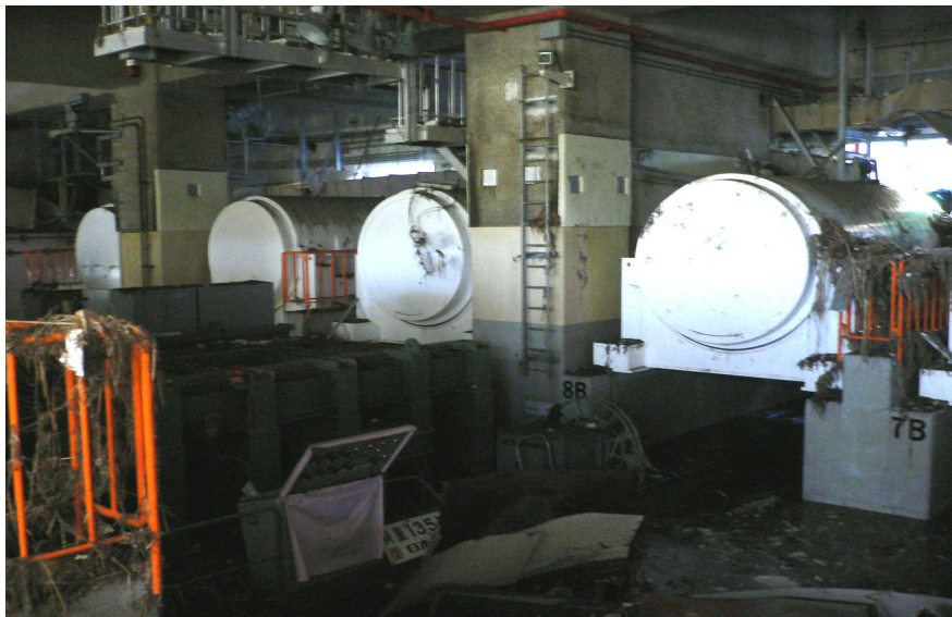
Figure 3 : Entreposage à sec (horizontal) des combustibles irradiés à Fukushima Daïchi, après le séisme et le tsunami
