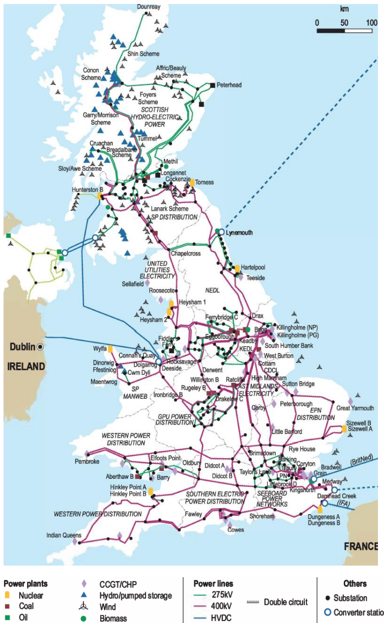
Figure 87 : Principales installations électriques du Royaume-Uni
