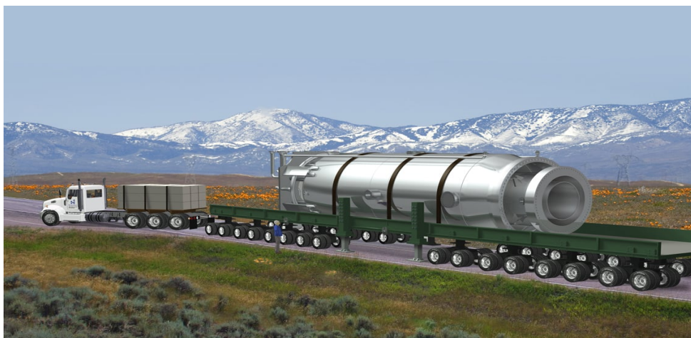
Figure 2 : Simulation du transport d'un réacteur NuScale
